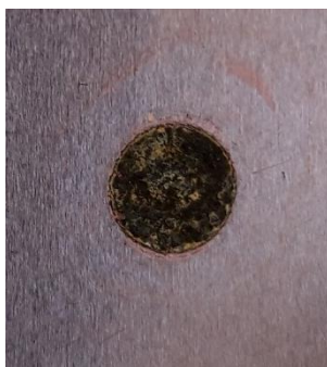
Abbildung 2-11: Fe-Abscheidung aus aufgelöstem Regolith: Links: metallisches Eisen auf Kupfer, Mitte: Elektroden und Elektrolyte, Rechts: EDX Analyse der Metallschicht
