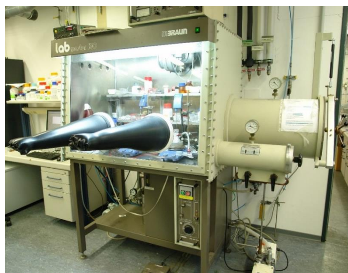
Abbildung 2-4: N 2 -gefüllte Glovebox, Luftfeuchtigkeit < 0.1%
