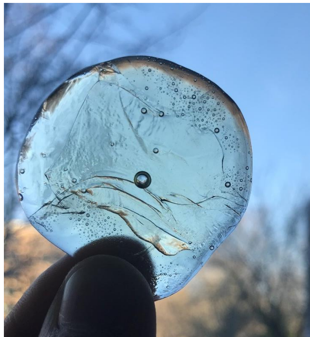
Abbildung 2-2: Glas hergestellt aus TUBS-T zur Herstellung von amorphen Strukturen.
