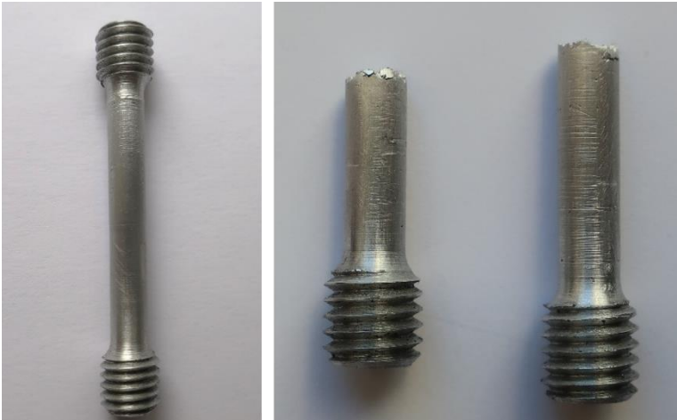
Abbildung 2-12: Zugprobe zur Ermittlung der Streckgrenze. Gefertigt durch Guss in gesinterter Regolithform und spanend nachbearbeitet.
