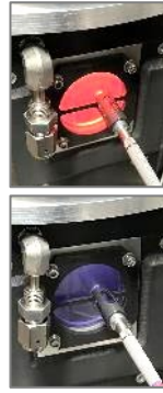
Bild 1a/b: An die Versuchskammer angepasste INCA-Quelle mit neuem Gaseinlassring (links) und FAN-Plasma (rechts oben) bzw. C4F8-Plasma (rechts unten)
