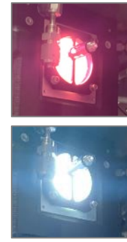
Bild 2a/b: Mikrowellenkopf auf Versuchskammer aufgesetzt (links) und FAN-Plasma (rechts oben) bzw. C4F8-Plasma (rechts unten)
