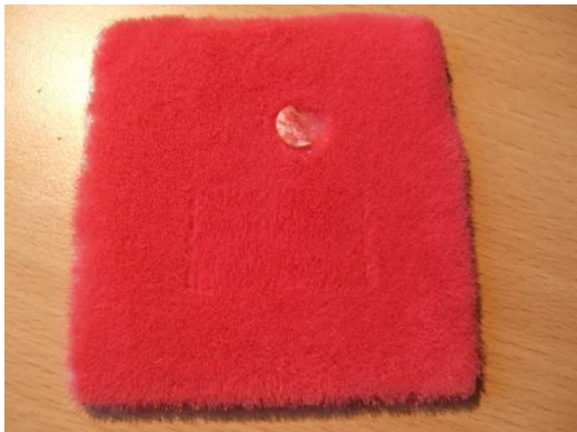
Abbildung 41: Fotografie einer beflockten Probe. mit 3 mm Flockfasern, Abriebfläche und Mischbruch bei Ausreißtest
