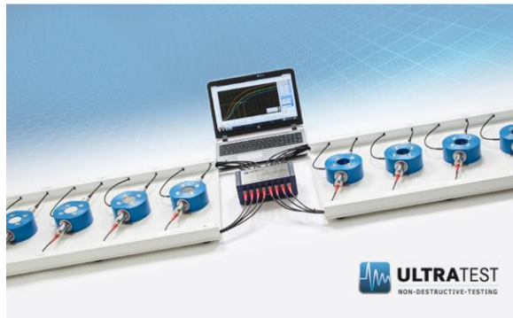
Abbildung 1: Messaufbau Aushärtemessung mit Ultraschall mit Standardmesszellen (links), Messung eines Abbindevorgangs eines anorganische Baustoffe (rechts).
