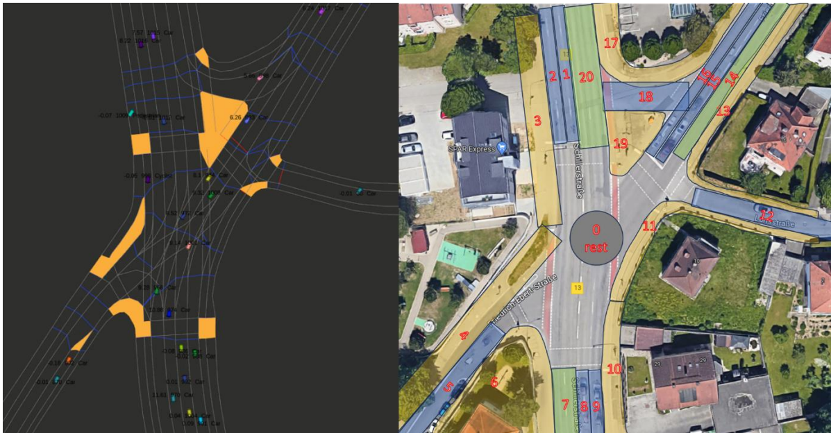
Abbildung 3: Links ist die fusionierte Objektliste die durch Echtzeitverarbeitung der Sensordaten generiert wird, in einer Birds-Eye-View Darstellung inklusive der genutzten Lanelet-Karte zu sehen. Rechts ist die virtuelle Segmentierung der 2D-Karte dargestellt, die dazu dient, feinkörnige Informationen für Verkehrssteuerungsalgorithmen zur Verfügung zu stellen. Diese Informationen werden mit der Objektliste verknüpft und auf dem Kafka-Server aktualisiert.
