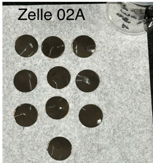
Abbildung 12: Sichtbares Lithium-Plating der Anoden.
