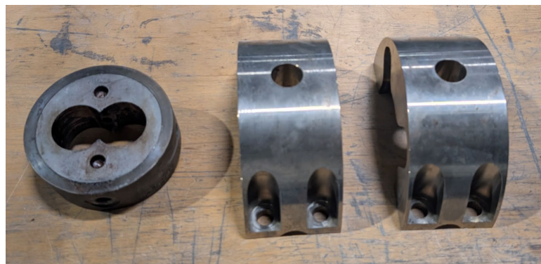
Abbildung 11: Messscheibe bestehend aus Gehäuseteil (links) und Flanschstücke oben und unten (rechts)
