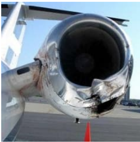
Abbildung 2: Beschädigte Turbine am hinteren Rumpf (exemplarisch)
