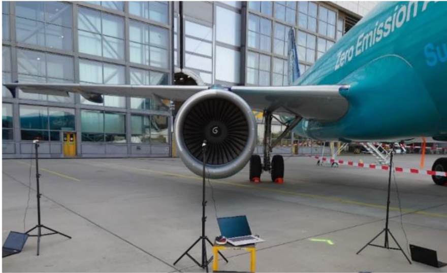
Abbildung 7: Schadensaufnahme simulierter Defekte an realem Fluggerät
