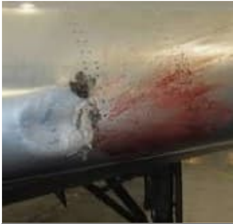
Abbildung 3: Beschädigung durch Vogelschlag (exemplarisch)
