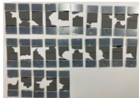
Abbildung 9: a) Zugfestigkeit nach Auslagerung 3YSZ-Substrat nach 100 h bei 835 °C in dualer Atmosphäre und Luft, b) Auslagerung 3YSZ-Substrat beidseitig mit Kathode bedruckt 100 h bis 3000 h bei 860 °C in Luft, c) Zugfestigkeit vor und nach Auslagerung, d) Substrat
