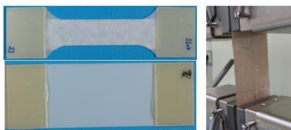
Abbildung 2: Getestete Zugstäbe mit Aufleimern für die Einspannung (links) und Zugversuch (rechts): Verwendung von Klebefolie zur Fixierung der Bruchstücke für die anschließende fraktografische Untersuchung
