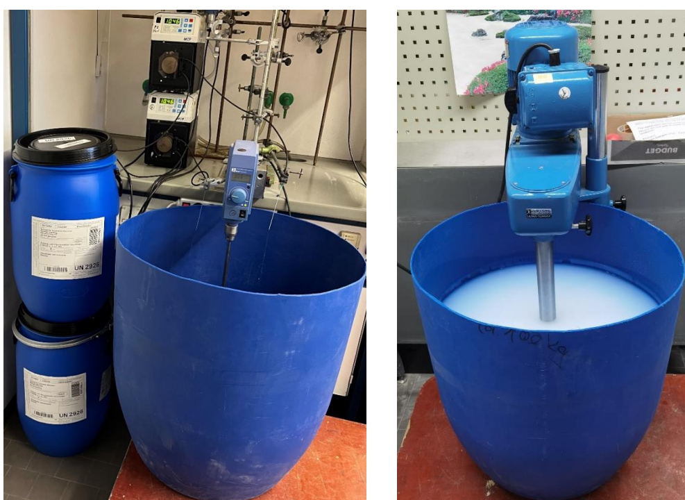
Abbildung 3: Experimenteller Aufbau des 100 L Großansatzes (links) mit anschließender starker Scherung mit Ultra Turrax T65 basic (rechts) an der TUM.
