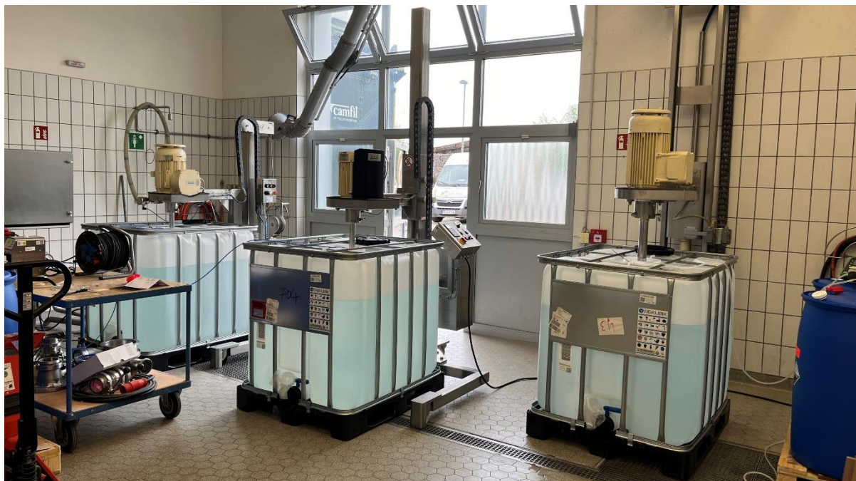
Abbildung 10: Experimenteller Aufbau von 3 gleichzeitig laufenden, je 1 m 3 -Ansätzen von „Si-Drill“-Feldspülung mit 2.5 % SiO 2 -Gehalt bei Fa. YSTRAL.
