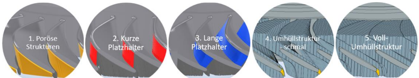
Abbildung 8: verschiedene erprobte Varianten der Stützstrukturen
