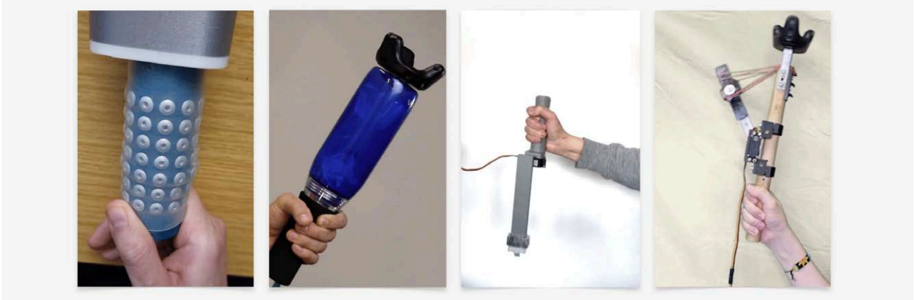
Die im Workshoprahmen untersuchten, prototypisch umgesetzten Kerntechnologien der Konsortiumspartner. Von links nach rechts: MorphGrip [1], MobileGravity [2], WeightLever [3], HapticCollider [4]
