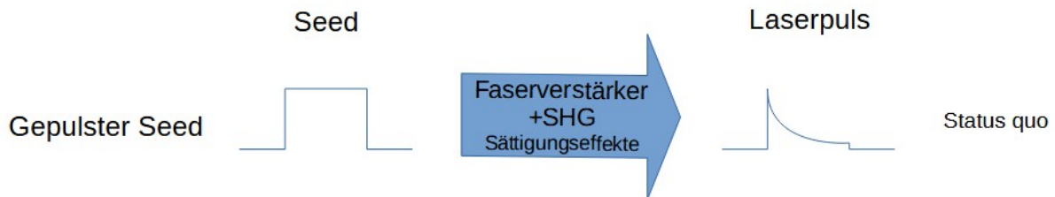
Abbildung 4: Durch Sättigungseffekte im Faserverstärker und SHG Modul bleibt eine Rechteckpulsform des Seedlasers nicht erhalten.
