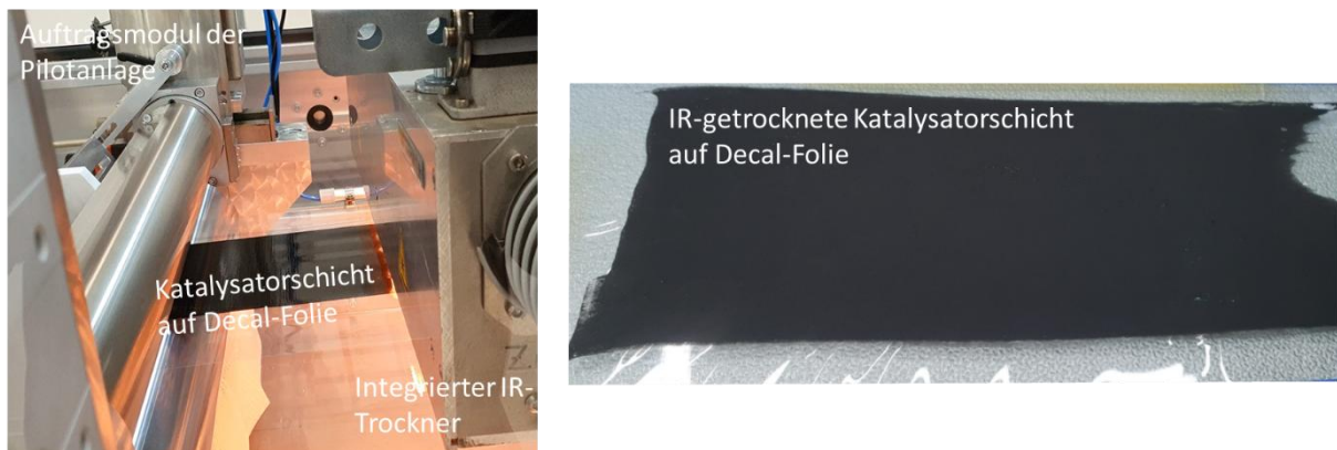
Abbildung 12: Integrierter IR-Trockner in die Pilotanlage zur Trocknung von Katalysatorschichten auf Decal-Folie sowie IR-getrocknete Katalysatorschicht auf der Decal-Folie
