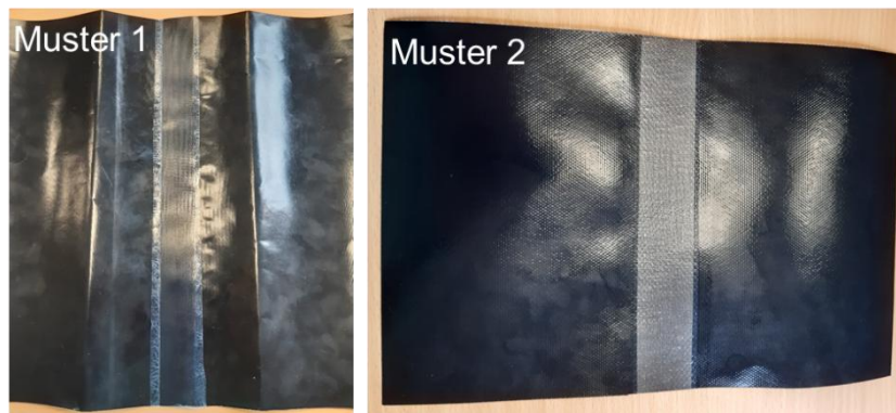
Abbildung 8: Probematerialien für das Beschichtungsband inklusiver Verbindungsstelle-/naht. Muster 1: Typ 1 von Hersteller A, Muster 2: Typ 2 Glasfaserverstärktes PTFE von Hersteller A inklusive Verbindung (vom anderen Partner durchgeführt, Spezialtechnologie).
