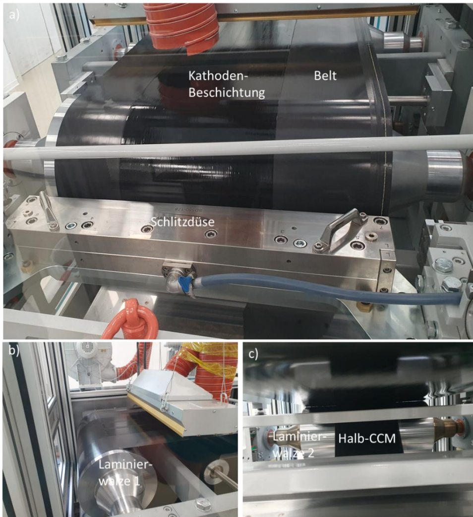
Abbildung 21: Herstellung einer Halb-CCM durch Verwendung des Primotyp inklusive Beschichtungs-Belt. A) Schlitzdüsenbeschichtung auf dem Belt, b) Trocknung der Katalysatorschicht mittels Laminierwalzen sowie c) Ansicht unter dem Beschichtungsbelt und die hergestellte Halb-CCM.
