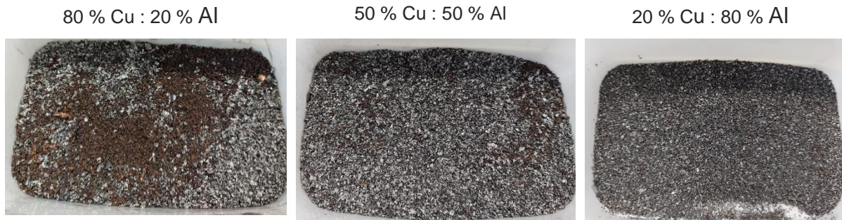
Abbildung 8: Verwendete Probenzusammensetzungen (Kupfer/Al)
