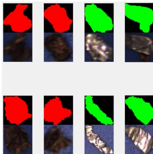
Abbildung 11: Segmentierte und klassifizierte Kupfer (rot)- und Aluminium (grün) Partikel
