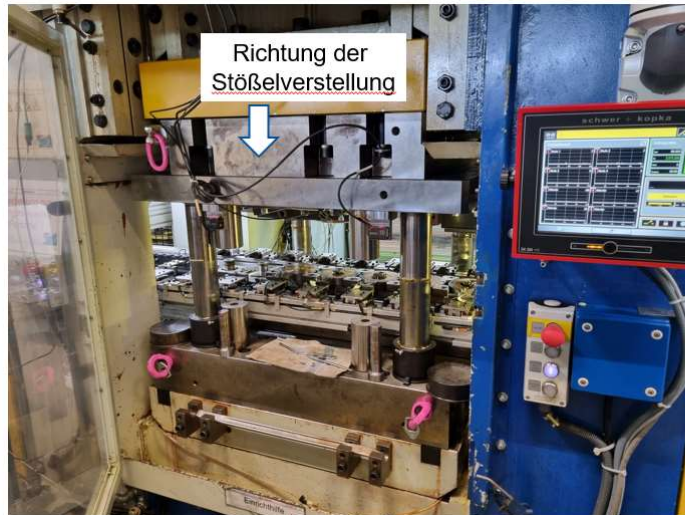
Abbildung 1: Versuchsaufbau bei der Eichsfelder Schraubenwerk GmbH (Quelle ESW)
