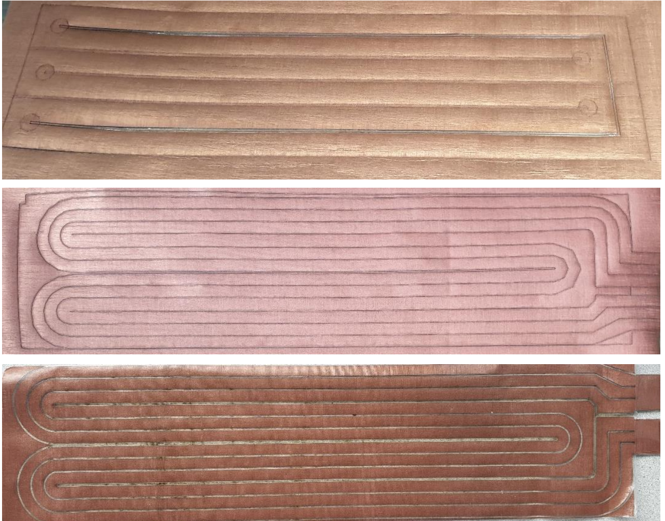
Abb. II.7. Heizstrukturen mit systematisch variierten Prozessparametern (Beispiel Form und Bahntrennung)
