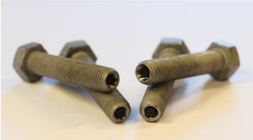
Abbildung 4: Sensorisch ausgestattete Schrauben der Größe M20.
