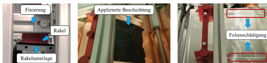
Abbildung 22: Seitenansicht der in den Prüfstand integrierten Nassbeschichtungsanlage (links), mittels Anlage applizierte Beschichtung (mittig) sowie infolge der Rakelkufen aufgetretene Schädigungen der Stromsammelrolle (rechts).
