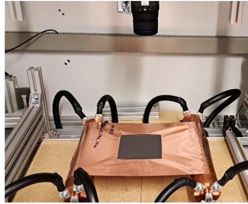
Abbildung 13: Prüfstand für die konduktive Elektrodentrocknung, schematisch links und im aufgebauten Zustand rechts gezeigt.
