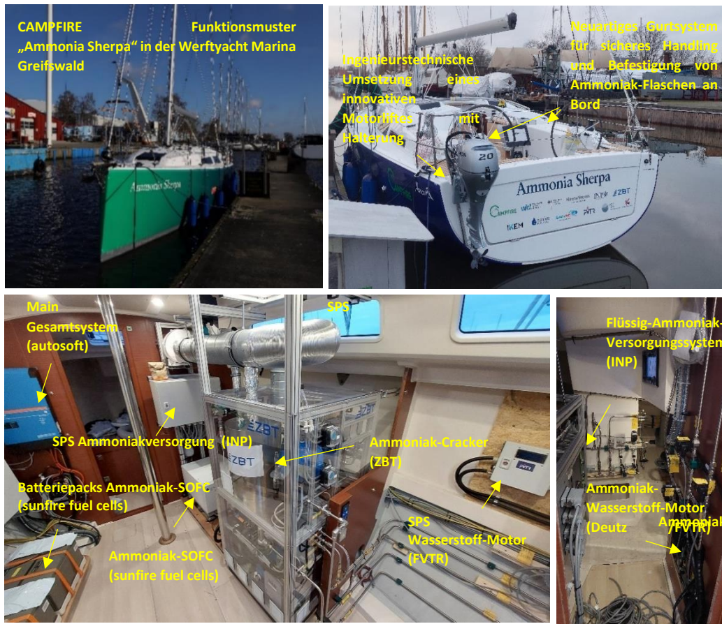
Abb. 2 Funktionsmuster Ammonia Sherpa mit integrierten Subkomponenten und angepassten ingenieurtechnischen Lösungen an Bord für den sicheren Betrieb
