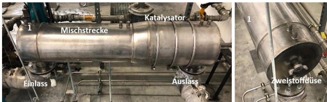
Abbildung 52. Aufbau des prozessintegrierten SCR Reaktors.
