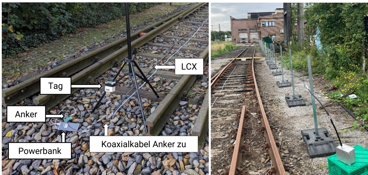
Abbildung 8: Foto Versuchsaufbau LCX-Ortung mit UWB mit 15 m LCX (links), aufgeständerte LCX-Installation des 50 m LCX am LCX-Testfeld in Dresden im Außenbereich der Schienenfahrzeughalle (rechts).
