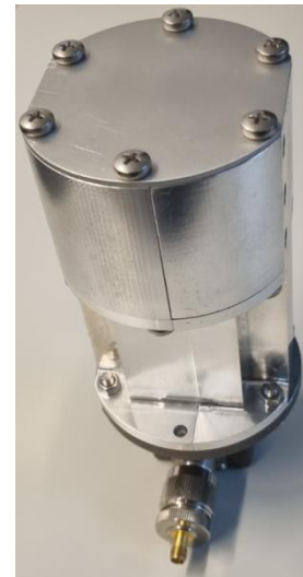
Abbildung 4: Hohlleitersimulator zur messtechnischen Charakterisierung von Metaoberflächen.
