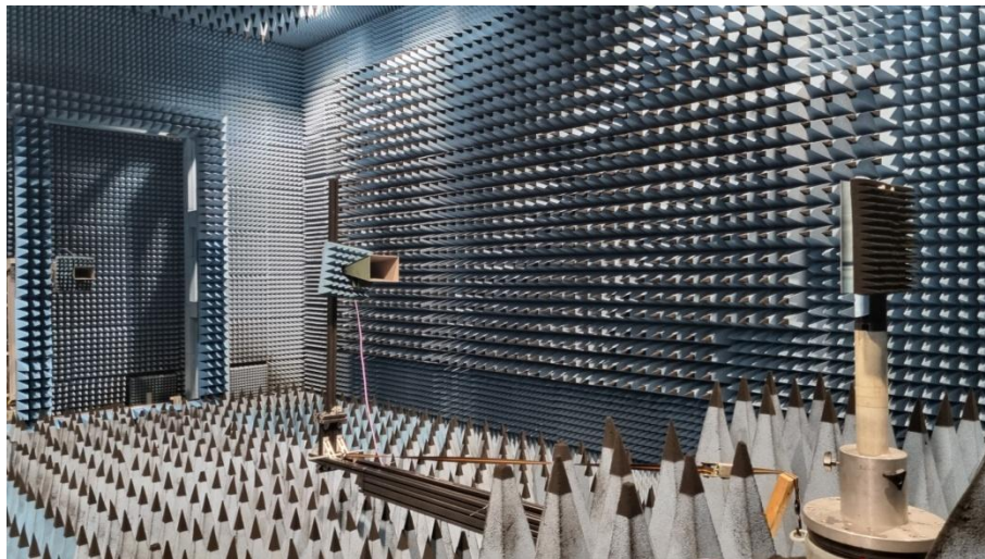
Abbildung 10: Messaufbau für bistatische RCS-Messungen in der IMST-Antennenmesskammer.
