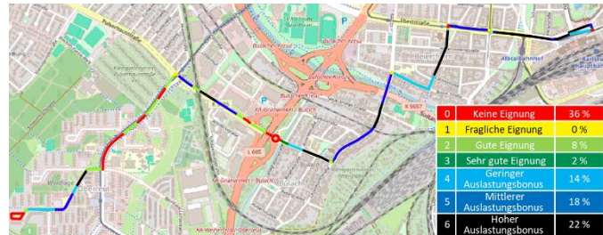
Abbildung 36: Ergebnis der Streckenbewertung am Beispiel der KVV Linie 50 in Karlsruhe
