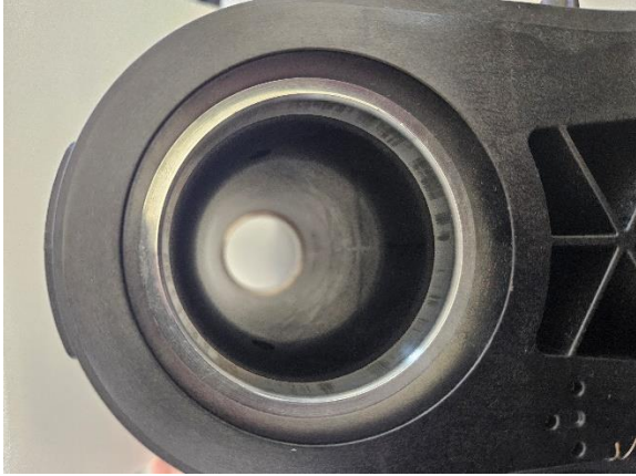
Abbildung 12: Steuerrohr mit integrierten Inserts zur Gabellagerung
