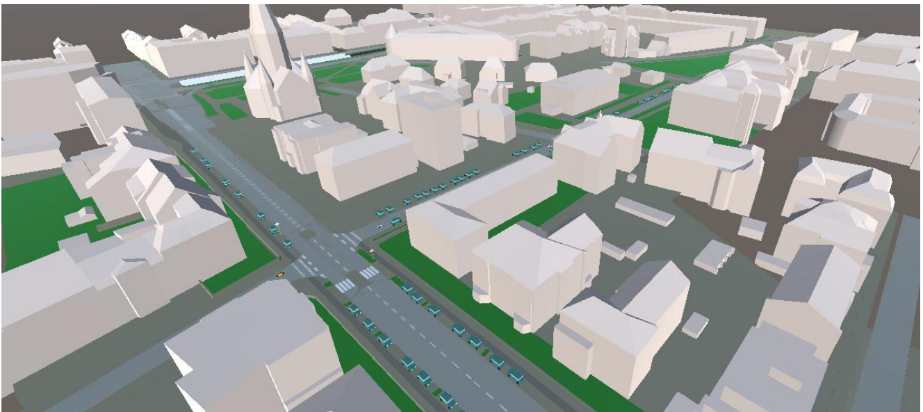
Abbildung 5: Simuliertes Karlsruher Stadtviertel mit originalgetreuen Straßenverläufen. An bestimmten Punkten entlang der Strecke werden über Checkpoints realistische Verkehrssituationen ausgelöst, darunter querender Autoverkehr oder Vorfahrtsmissachtungen.
