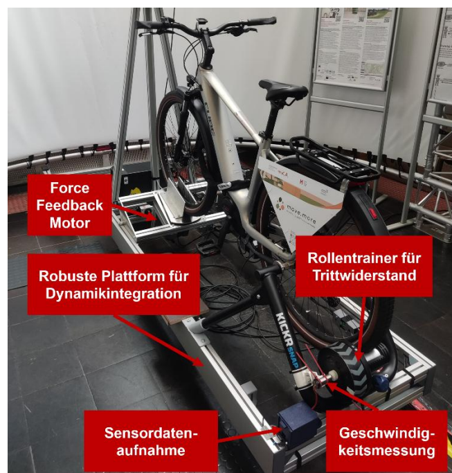
Abbildung 3: Aufbau des Fahrradsimulators mit einheitlicher Plattform für die Integration möglicher Dynamiksysteme und einem Force-Feedback Motors zur Messung des Lenkwinkels und Adaption des Lenkwiderstands.
