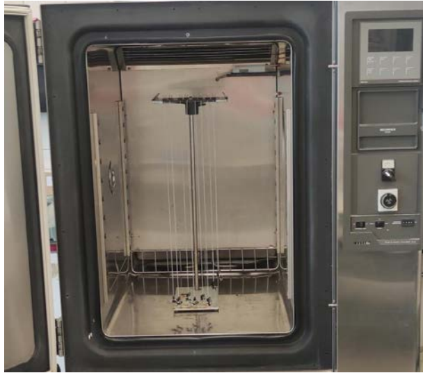
Abbildung 9: Aufbau für die thermische Nachbehandlung der Membranen in feuchter Luft in einer Klimakammer.
