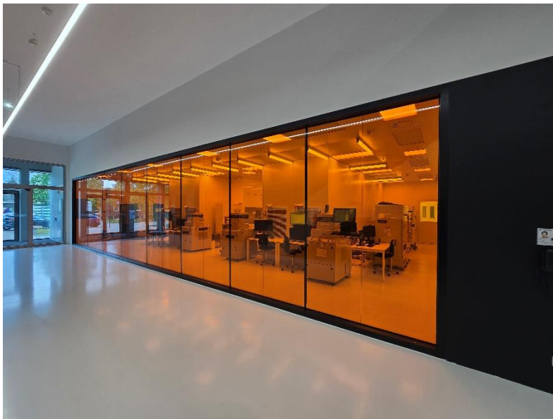
Abb. 1 Reinraum des ZAQuant. Rechts hinten ist der beschaffte 3D Drucker zu sehen. Der Elektronenstrahlschreiber ist im hinteren Bereich des Reinraums installiert, der durch eine separate Schleuse vom abgebildeten Bereich getrennt ist.
