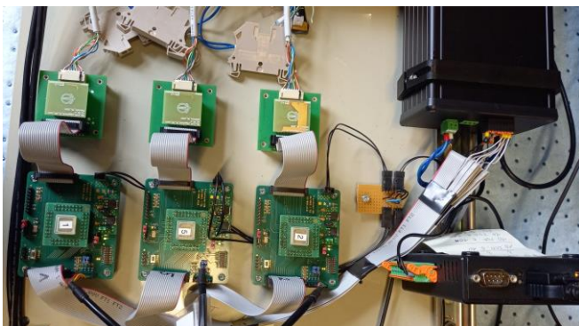
Abbildung 12: Messaufbau bei GFE. KI-BOBs mit FPGA an PC
