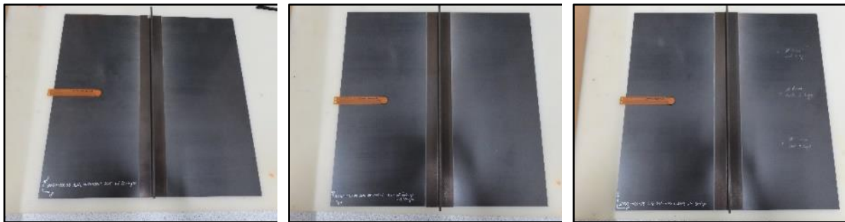
Abbildung 15: Gefertigte Probekörper mit verklebtem Stringer (von links nach rechts: Probekörper ohne Fehlstellen, Probekörper mit Fehlstellen in Form von Sacklochbohrungen, Probekörper mit Fehlstellen in Form von Fremdkörpern)
