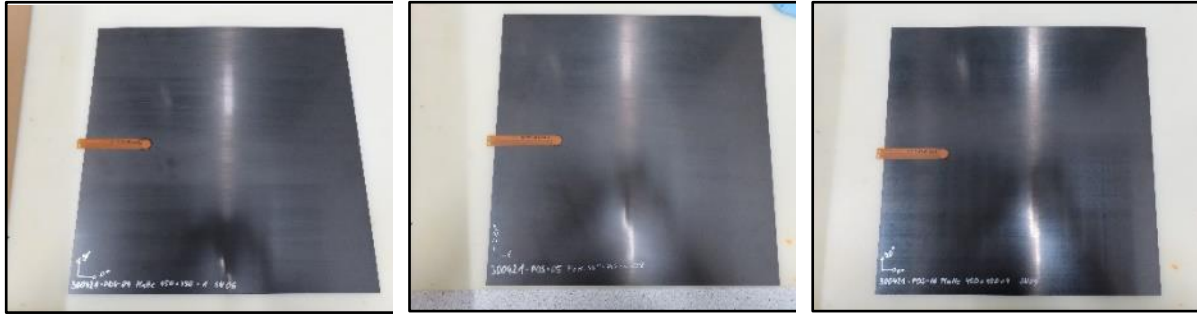
Abbildung 11: Gefertigte Referenzprobekörper ohne Fehlstellen (von links nach rechts: Probekörper mit den Laminatdicken 1 mm, 2 mm und 4 mm)
