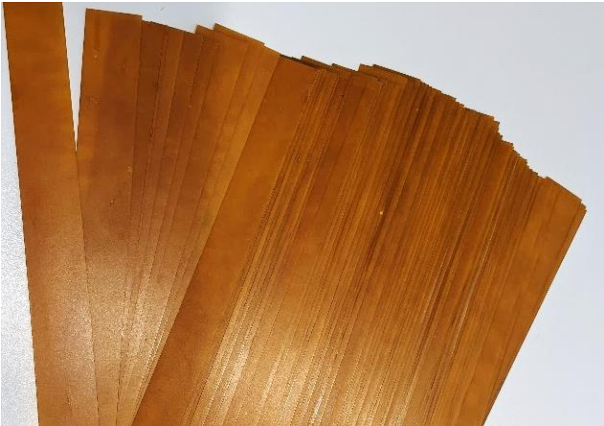
Abbildung 22: Probekörper aus Aktuatorssubstrat für Untersuchungen an flexiblen Strukturen mit verschiedenen Klebstoffen
