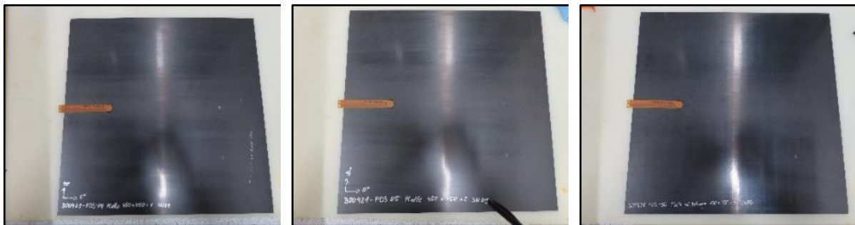
Abbildung 12: Gefertigte Probekörper mit integrierten mit Fehlstellen in Form von Sacklochbohrungen (von links nach rechts: Probekörper mit den Laminatdicken 1 mm, 2 mm und 4 mm)
