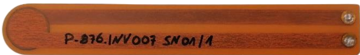
Abbildung 29: Piezoelektrischer Flächenwandler mit verlängerten Anschlussleitungen, Abzuglasche und 15 mm Keramikdurchmesser
