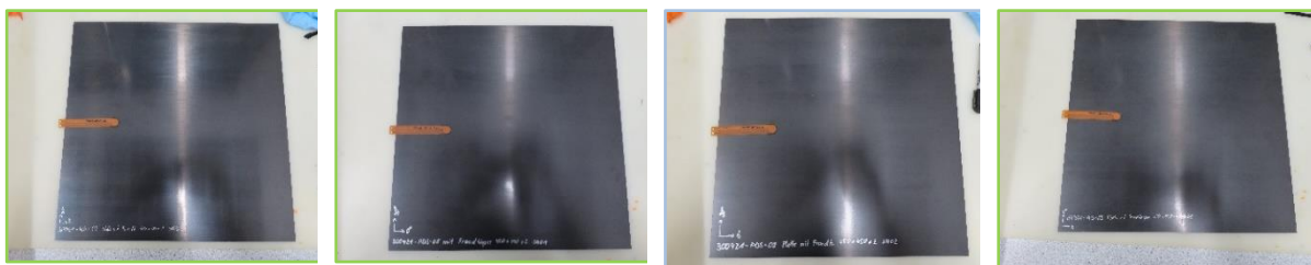
Abbildung 13: Gefertigte Probekörper mit integrierten Fehlstellen in Form von eingelegten Schutzfolien. (von links nach rechts: Probekörper mit den Laminatdicken 1 mm, 2 mm, 2 mm und 4 mm; Grüner Rahmen: Probekörper mit Folientyp 1, blauer Rahmen: Probekörper mit Folientyp 2)
