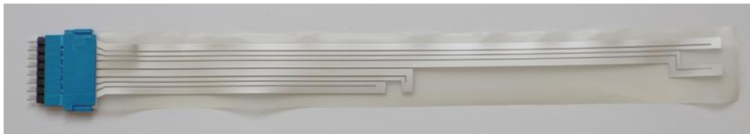
Abbildung 5: Gedruckte Schaltung auf TPU-Substrat mit standardisiertem Steckverbinder
