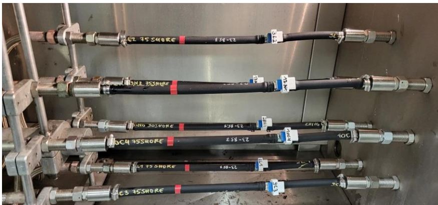
Abbildung 14: Probekörper in Druckpulstest
