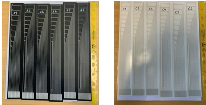
Abbildung 4: Gedruckte Schaltungen; links: TPE/TPV-Substrat, rechts: TPU-Substrat
