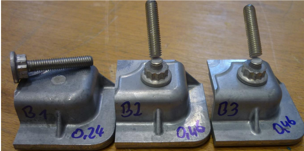
Abbildung 2 Beispielhafte Ergebnisse Reibschweißversuche, links n.i.O, Mitte und rechts i.O.
