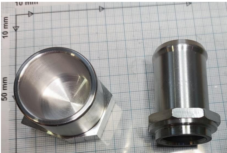
Abbildung 11 gedrehter "Reibschweißdummy" sowie Medienanschluss (beides aus EN AW-6082 T6)
