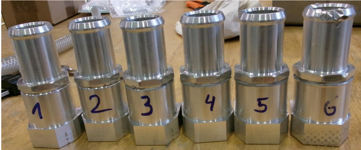
Abbildung 12 Proben mit verschiedenen Reibschweißparametern
