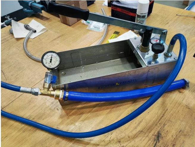
Abbildung 9 Aufbau Dichtheitsprüfung mit Handpumpe und Manometer
