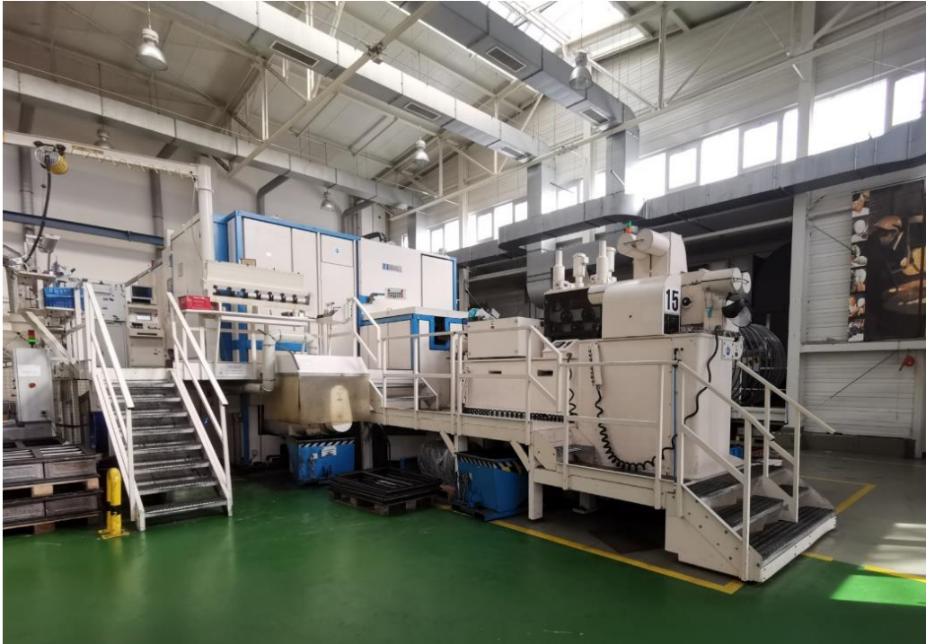
Abbildung 14 6-Stufen Presse FXP86M am Standort Bärenstein
