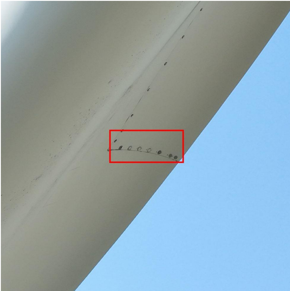
Abbildung 9: Drohnenbild eines Rotorblatts mit Fehlstellenmarkierung
