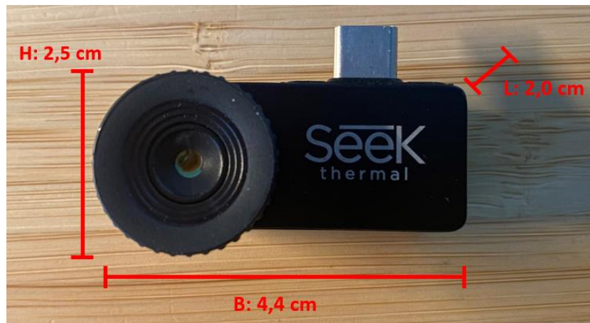
Abbildung 12: Thermal Seek Compact Kamera für die Wärmebilderstellung mittels Smartphone
