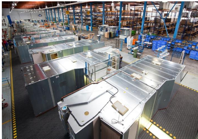
Abbildung 17: Fließbandfertigung der Passagierkabinen bei EPC: Bereits vorinstallierte Verkabelung (oben) und der zu verschweißende Kabinengrundrahmen (unten) (Quelle: EMS PreCab)
