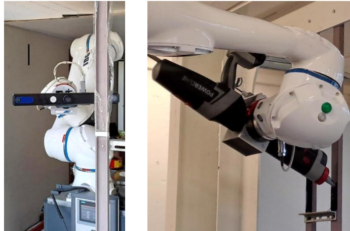
Abbildung 10: Links Optisches Sensorsystem zur Referenzierung im Raum und Lokalisierung der Fügeflächen Rechts Applikationssystem für den Klebstoff (Quelle: MEYER WERFT)
