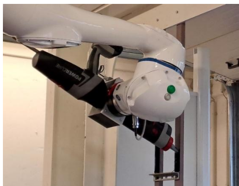
Abbildung 7: Im Forschungsvorhaben für die MEYER WERFT entwickeltes System zur Klebstoffapplikation in einer Kabine (Quelle: MEYER WERFT)
