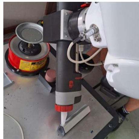
Abbildung 20: Robotersystem in der Kabine und verschiedene Arbeitsschritte zur Vorbereitung des Klebstoffauftrags und der eigentliche Klebstoffauftrag (Quelle: MEYER WERFT)
