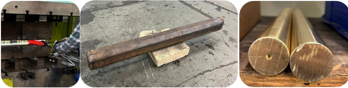
Abb. 9: Warmumformung von Halbzeugen alternativer Metalllegierungen (TU-Freiberg)
