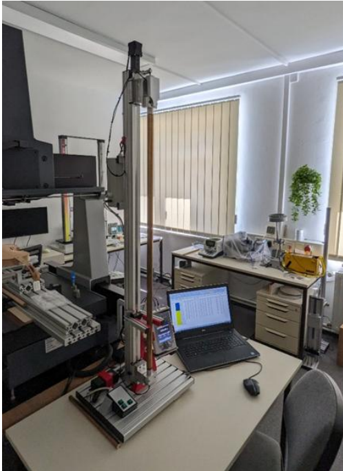
Abb. 7: Ultraschallprüfstand nach dem Umbau auf große Metallproben
