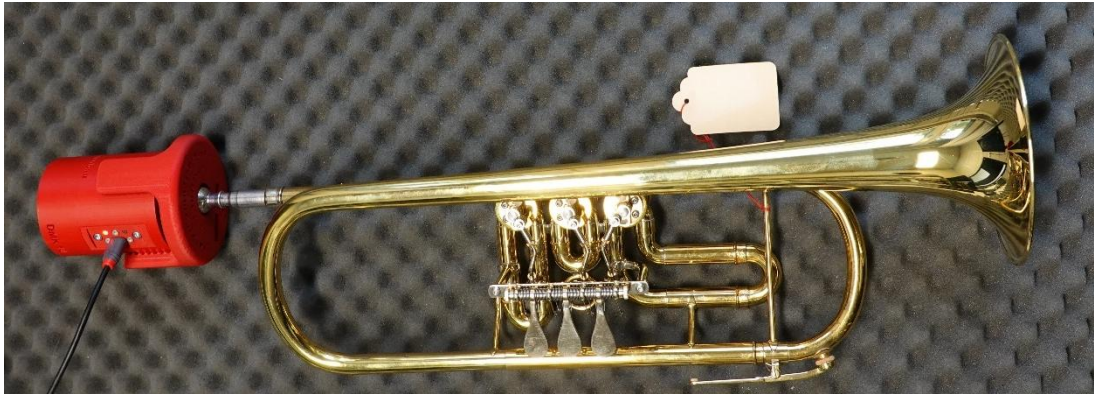
Abb. 22: Messung der Eingangsimpedanz der Mustertrompeten
