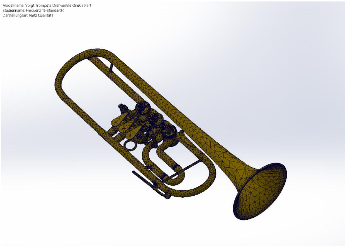
Abb. 1: FEM-Vernetzung des Modells
