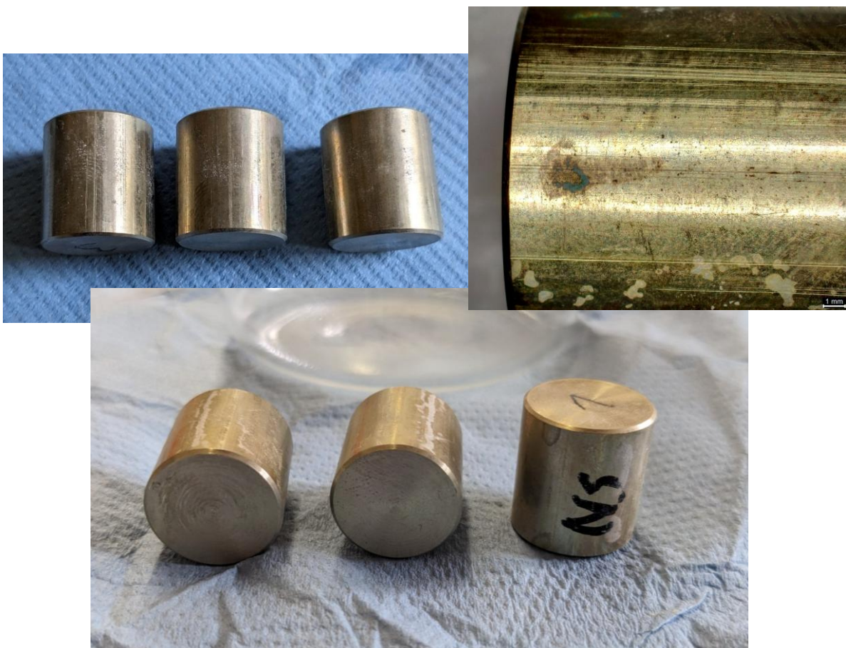
Abb. 14: Korrosionsversuche (Neusilber \text{CuNi7Zn39Mn5Pb3} )
