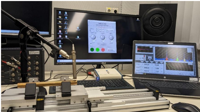
Abb. 4: Modalanalyse zur Ermittlung der Dämpfung und der Klangdauer
