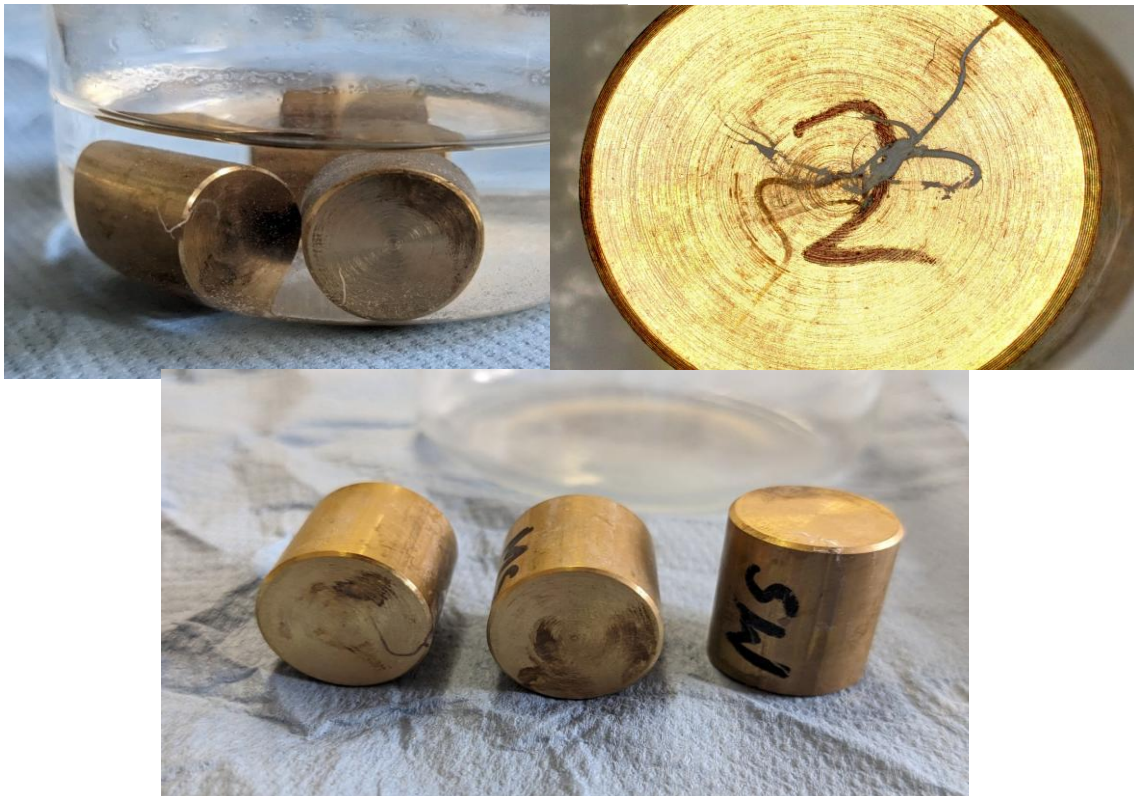
Abb. 13: Korrosionsversuche (Messing CuZn39Pb3)
