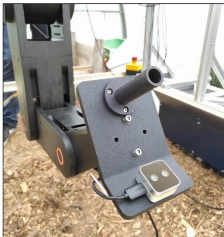
Abbildung 2: Saugeinrichtung und Kamera montiert am Roboterarm.
