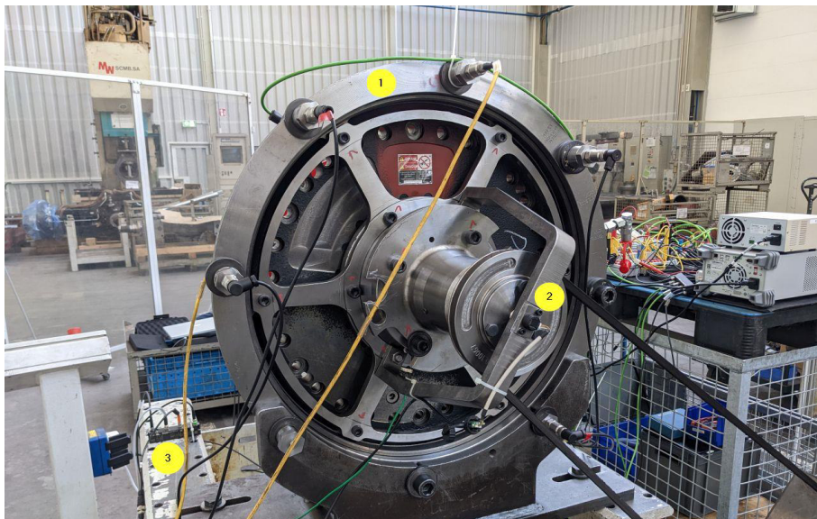
Abbildung 6: Montierte Sensoren am Leerlaufprüfstand
