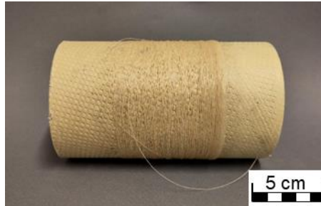
Abbildung 16: Im Labormaßstab gesponnenes Filament mit 40 % PHB-Anteil
