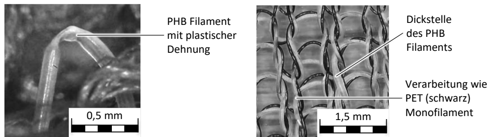
Abbildung 18: Mikroskopiebilder der Strickversuche mit PHB-Monofilament. Rückmeldung zur Anpassung des Spinnprozesses aufgrund von zu hoher plastischer Dehnung (links) und auftretenden Dickstellen (rechts). Grundsätzliche Verarbeitbarkeit aber gegeben.
