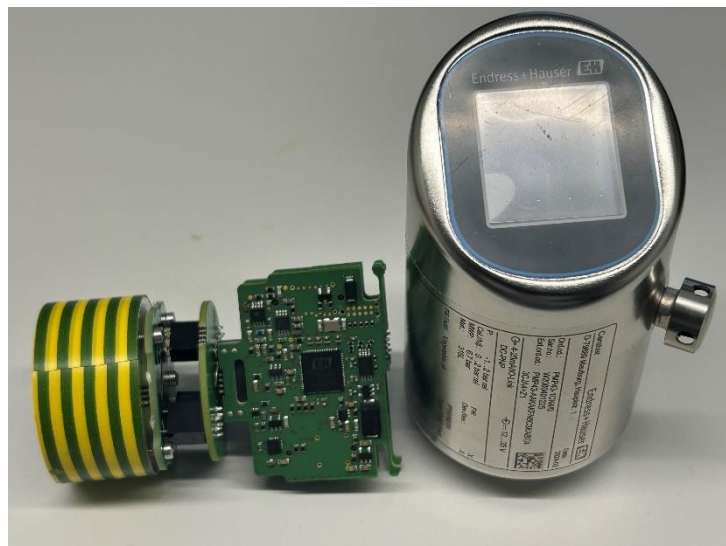
Abbildung 9: Finales Funktionsmuster. Links ist der Resonator mit Elektronik abgebildet. Der komplette Sensor wird in das Gehäuse (rechts) eingebracht.
