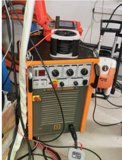
Abb. 2 In den Versuchstand integrierte Schweißstromquelle
