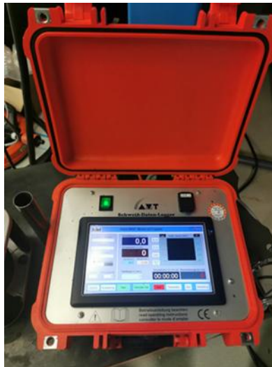
Abb. 4: Integrierter Schweißdatenlogger am Versuchstand
