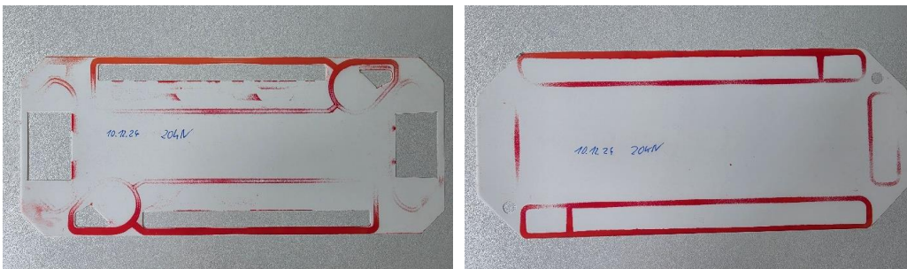
Abb. 26 Druckmessfolie der oberen IDM-Platten, links: obere IDM-Platten untereinander, rechts: untere, medienleitende IDM-Platte zum Stack.
