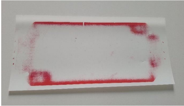
Abb. 21: Druckmessfolie nach Druckversuch medienleitenden IDM-Platte zu ebenem Untergrund.
