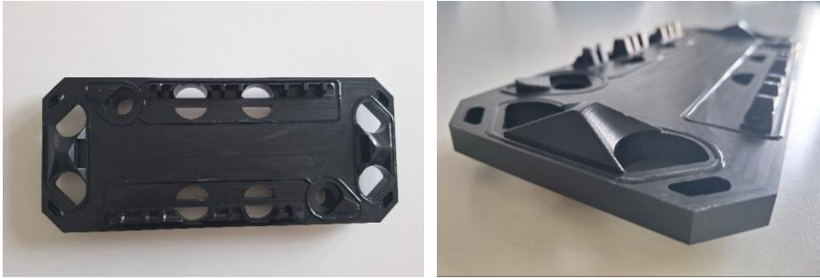
Abb. 24: Obere, medienführende IDM-Platte mit erneut nachgefräster Dichtkontur (so dass eine Nut entsteht) und mittels Dispersion aufgetragenes Dichtmittel.
