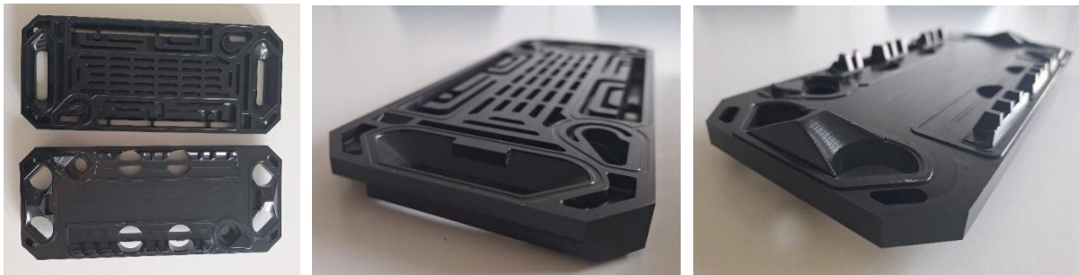
Abb. 22: Links: untere und obere IDM-Platte, mittig: untere IDM-Platte mit Dicht-Nut; rechts: obere IDM-Platte mit Dicht-Steg.
