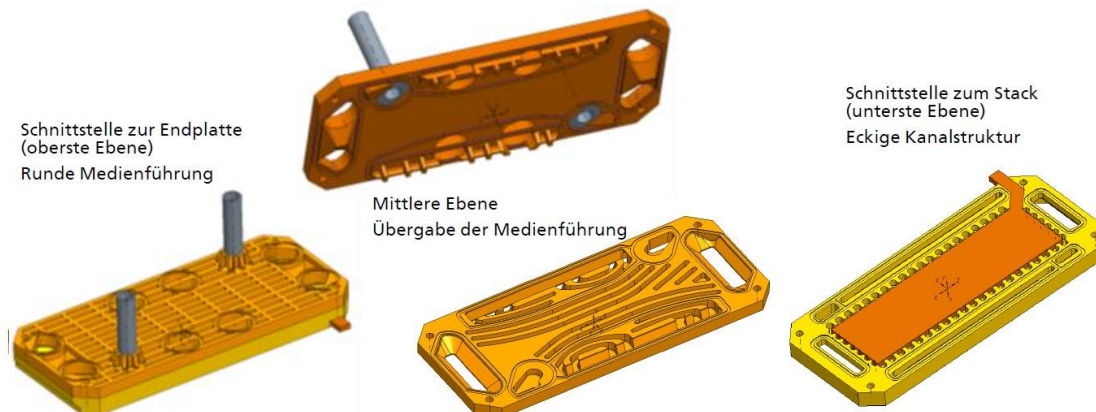
Abb. 14: CAD-Darstellung der beiden oberen IDM-Platten mit den einzelnen Ebenen der Medienübergabe, rechts: Unterseite medienlenkende IDM-Platte mit Stromabnehmer zur Stackseite.
