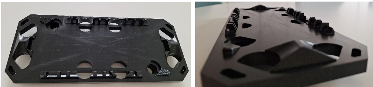
Abb. 23: Obere, medienführende IDM-Platte mit nachgefräster Dichtkontur.
