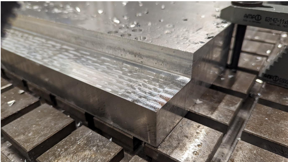
Abbildung 6: Oberflächengüte nach dem Eckfräsen mit einem Hochvorschubfräser
