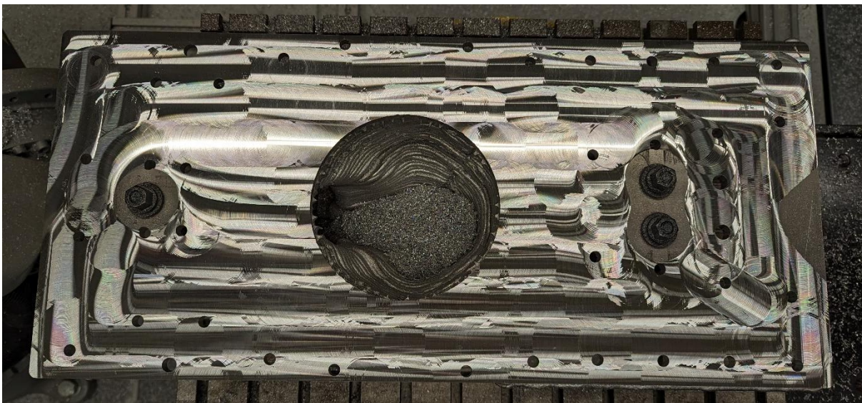
Abbildung 5: Plangefräste Fläche, gefertigt mit einem PKD-Fräser
