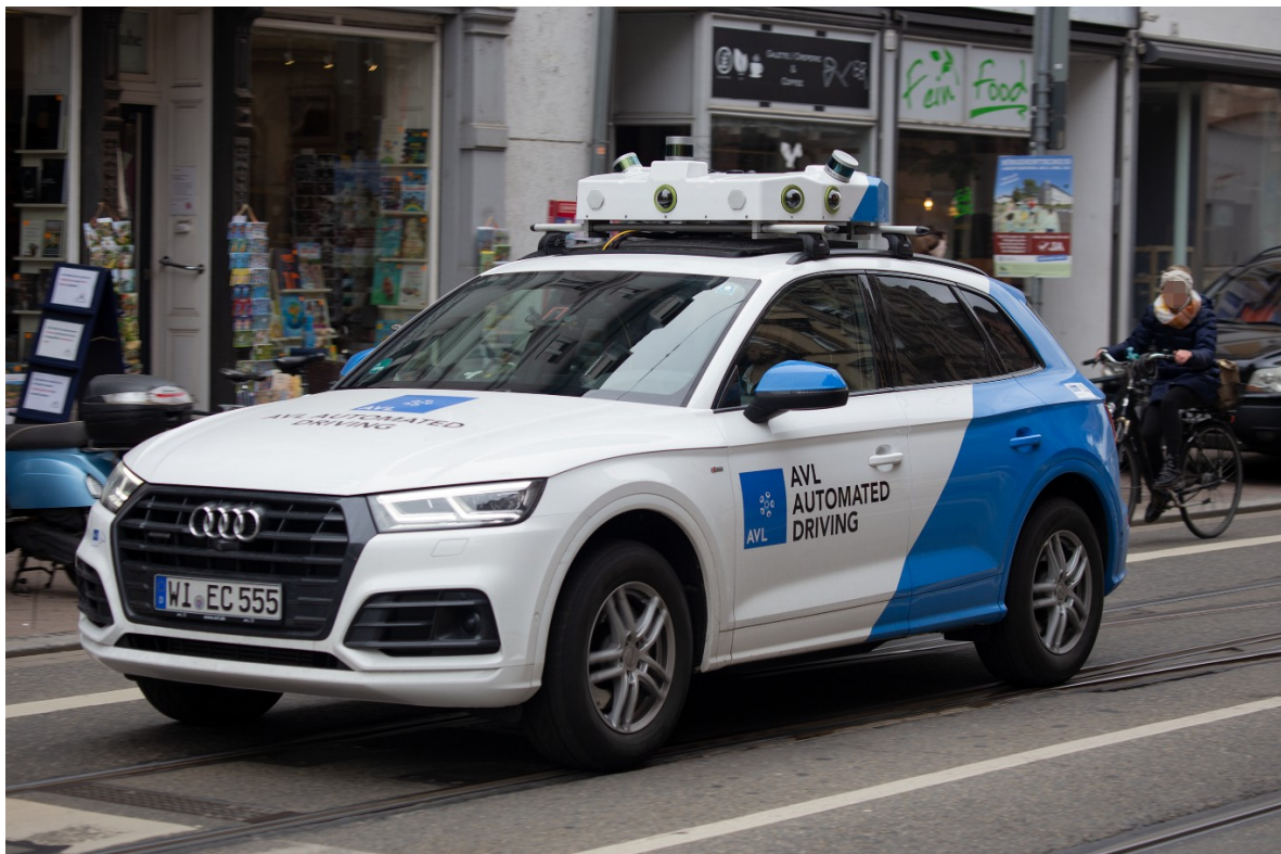
Abbildung 1: Messfahrzeug mit AVL Dynamic Ground Truth System zur Entwicklung hochautomatisierter Mobilitätssysteme
