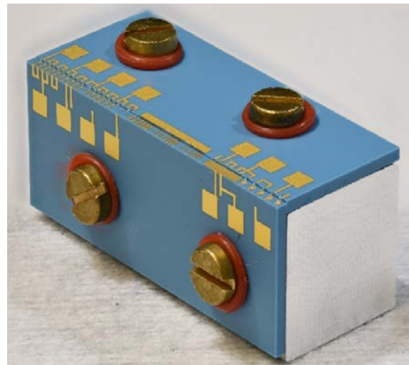
Abbildung 2: Demonstrator LTCC mit Wire Bond auf Stirnseite der LTCC
