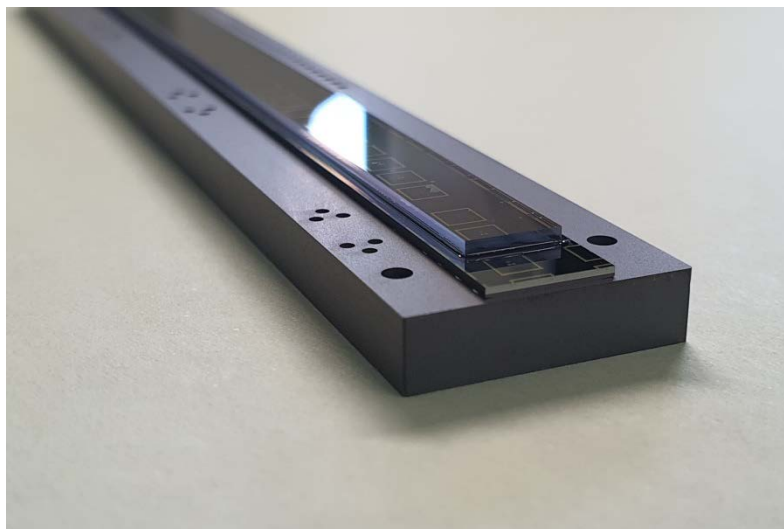
Abbildung 1: Demo-Carrier mit Dummy-Chip und Dummy-Filter
