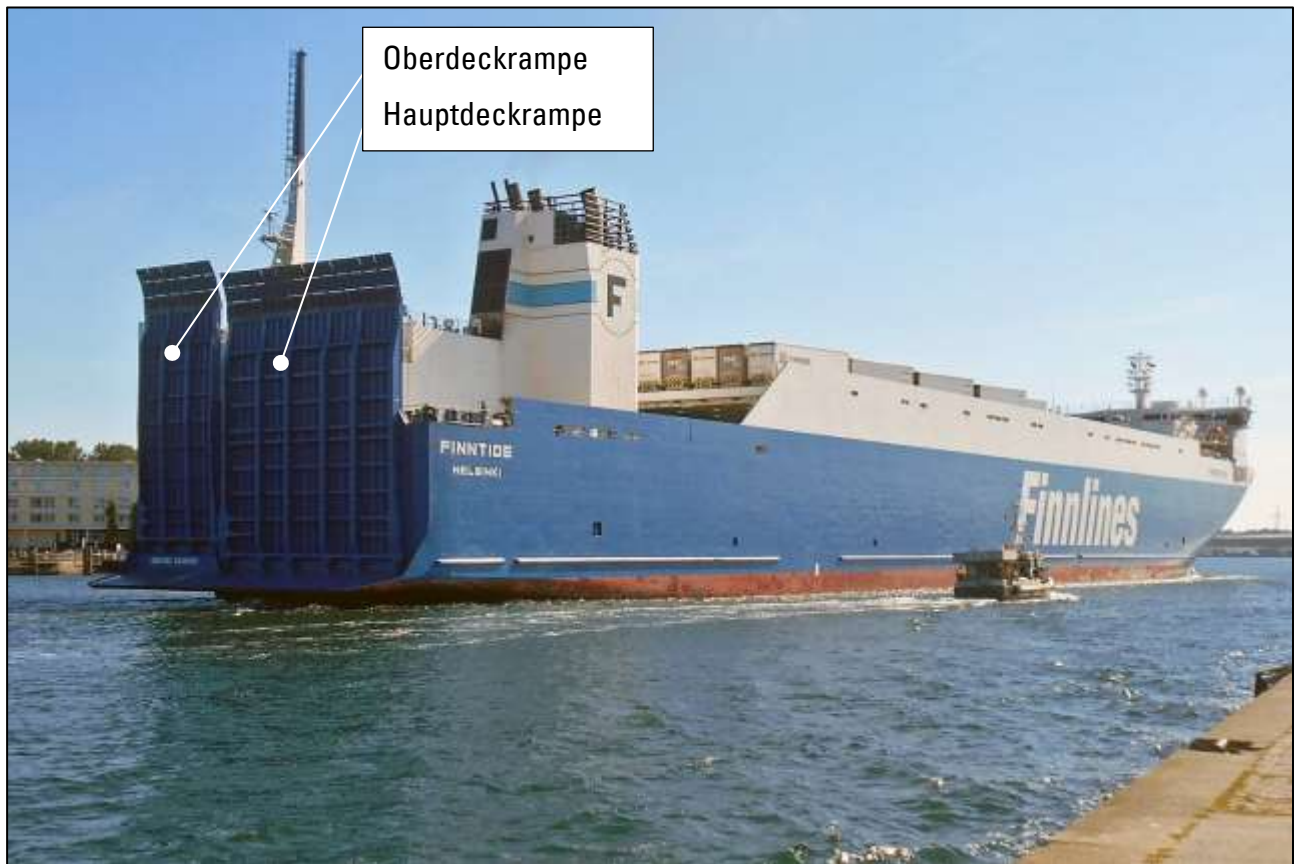
Abbildung 8: Zweiteilige Rampe am Heck der RoRo-Schiffe der Finnbreeze-Klasse (hier „Finntide“, Quelle: Wikipedia)
