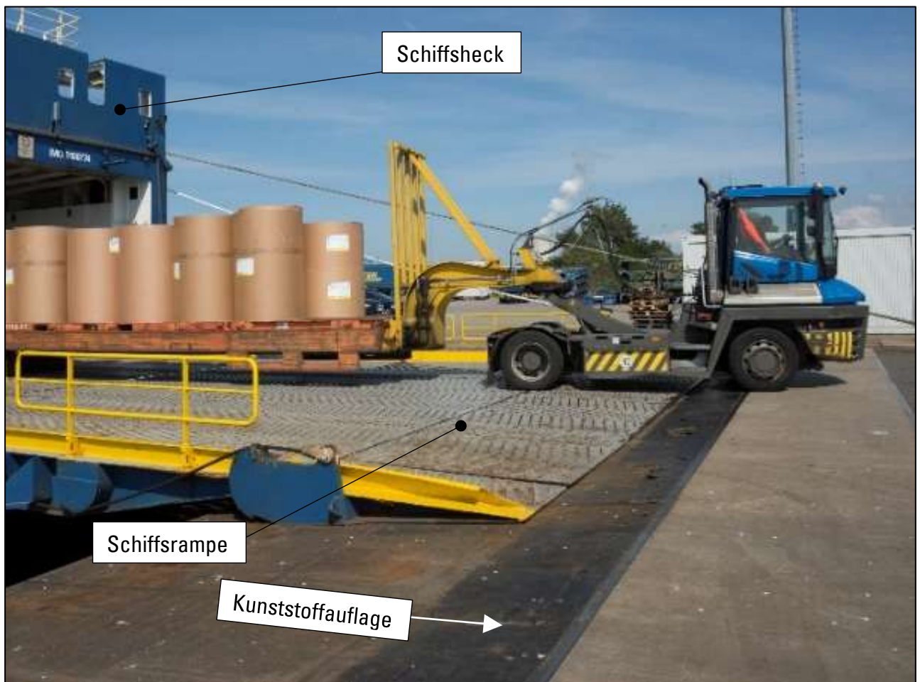
Abbildung 3: Entladung eines RoRo-Schiffes am Liegeplatz 60 - Überführung der Schiffsrampe durch eine Zugmaschine (Tugmaster) mit Trailer
