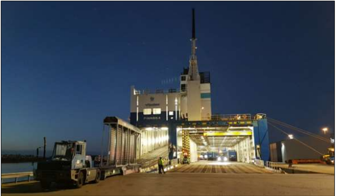
Abbildung 7: Positionierung der mobilen Schallschutzwand während des Feldversuchs am 01.11.23 auf der Oberdeckrampe, die damit für den RoRo-Umschlag blockiert ist
