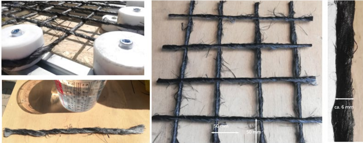
Abbildung 14: Bewehrungsfertigung der ersten Bewehrungsstrukturen mit hohem Faserabrieb und hoher Faserstaubbelastung (HTWK)
