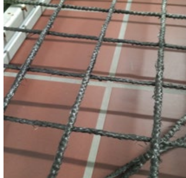
Abbildung 16: entwickelter Umwindungsprozess zur Stabilisierung der R-Garne
