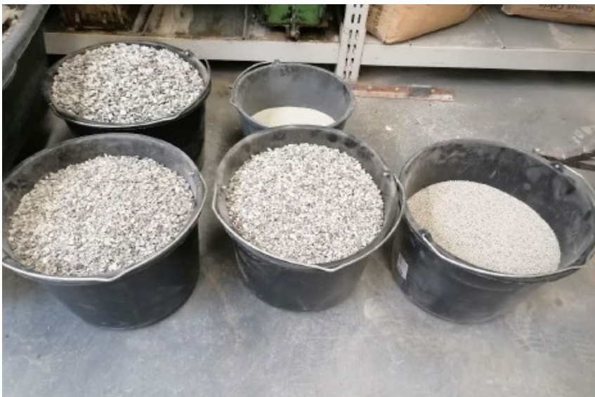
Abbildung 8: Rezyklat sortiert in KG < 0,25, KG 0/2, KG 2/8 und KG > 8
