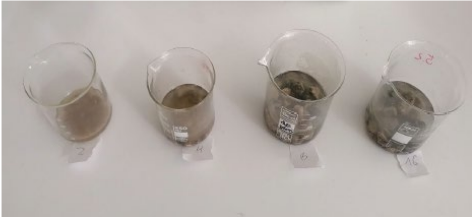
Abbildung 6: Bestimmung des Zementsteingehaltes an Proben eingelegt in Lösung aus Amidosulfonsäure und Wasser
