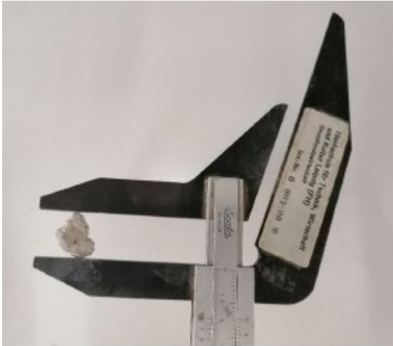
Abbildung 7: Prüfung der Kornform im Labor zur Bestimmung des Shape Index SI
