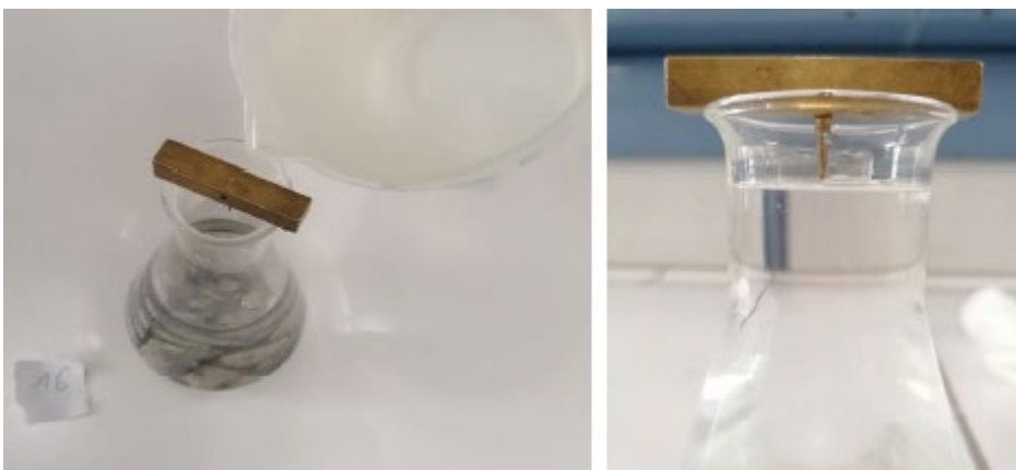
Abbildung 5: Pycnometer-Verfahren zur Bestimmung der Rohdichte der rezyklierten Gesteinskörnung
