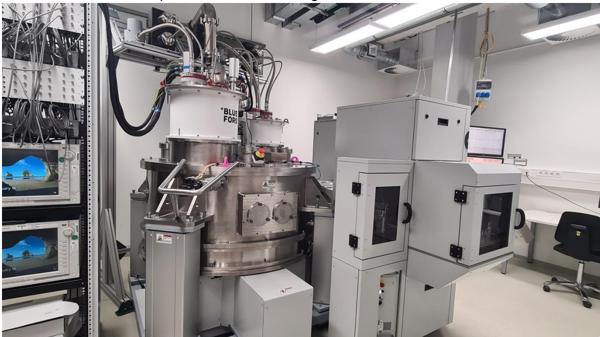
Abbildung 2: Der aufgebaute 300mm Kryogenen Wafer Probers am Fraunhofer IAF.
