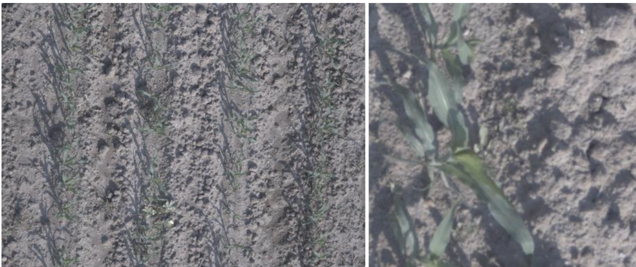
Abb. 3: Abbildungsleistung Zenmuse P1 aus 15m (links), SAM-Dimension aus 60m (rechts).
