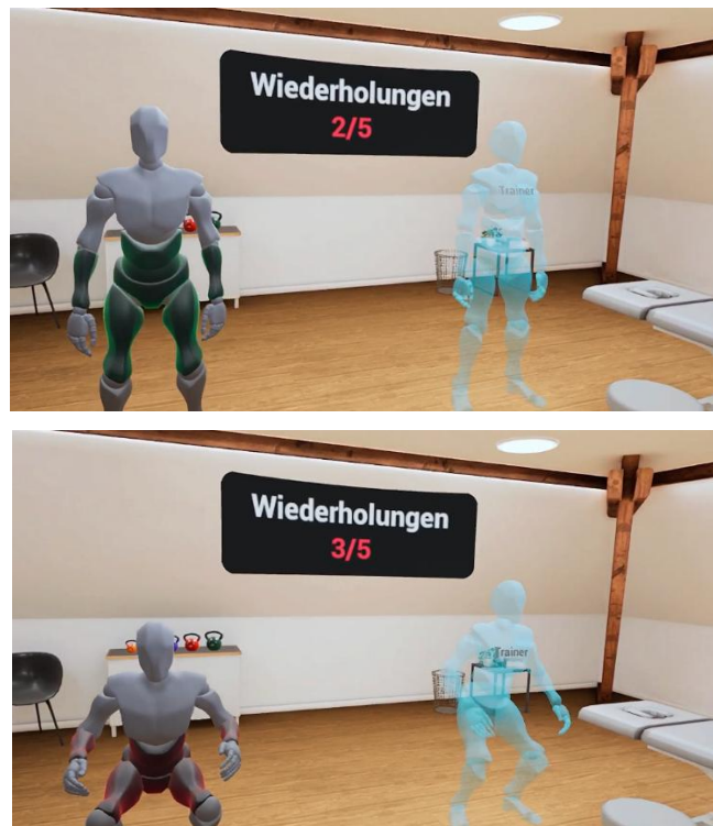
Abbildung 5: Darstellung der Nutzeransicht während der Kniebeugestudie: Links die verspiegelte Eigenansicht der Nutzer:in, rechts die Referenzausführung als Avatar. Bei Abweichungen erfolgte eine korrektive Unterstützung mittels EMS.
