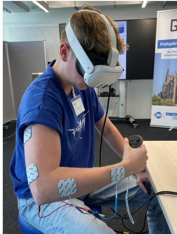
Abbildung 8: Detailansicht der Nutzerinteraktion mit dem "interaktionsKRAFT"-Demonstrator, erkennbar sind die Meta Quest 3 VR-Brille, der Controller und die applizierten EMS-Elektroden zur Gewichtssimulation.
