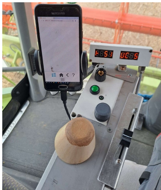
Bild 10: Linke Armlehne mit Joysticklenkung, RSME-Erfassung und VA-Bedienung
